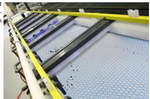
Eine Decke aus Abdeckkugeln von Euro-Matic erlauben Produkte oder Geräte, die sich durch die Flüssigkeitsoberfläche bewegen. Die Kugeln werden beiseitegeschoben, aber ihre Abdeckung wird schnell wiederhergestellt, wenn sich die Ausrüstung vorwärtsbewegt oder Produkte vom Tank abgehoben werden. Die Kugeln steigen und fallen mit dem Flüssigkeitsstand in den Lagertanks und sorgen für eine konstante Abdeckung von Flüssigkeiten, die in Behältern mit geneigten Seiten aufbewahrt werden.
